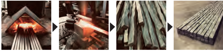
コークス炉で材料を熱する 専用ハンマーや鋤を使って叩く 鋤目の入った材料を冷ます 反り・捻じれを修正して完成
